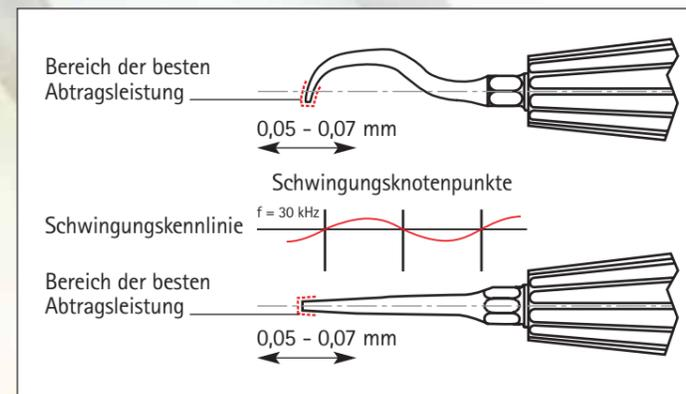
Die Bewegung der Spitze erfolgt linear zur Handstückachse. Optimale Abtragsleistung mit einer Schwingweite zwischen 0,05 und 0,07 mm bei einer Schwingfrequenz von 30 kHz.
