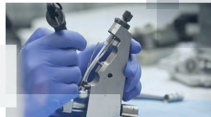
De olika delarna sätts samman till ett KaVo-instrument
