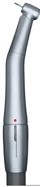
COMFORTdrive 200 XD vinkelstycke Vinkelstycke med hög hastighet, mycket enkel och mångsidig, integrerad borstlös motor, ljusledarstav i glas, keramiskt kullager, sprayfilter som kan bytas ut av användaren, spray med tre munstycken, endast lämplig för direkt anslutning till KaVo COMFORTbase™, högsta hastighet: 200 000 varv/min. Art. nr. 1.000.5500
