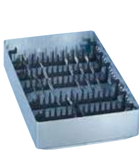
E 441/1 innsats 1/4 • Instrumentrist for mikroinstrumenter • Trådgitter med 1,7 mm maskevidde, lukkede sider, kan stables • Innvendig inndeling med 6 justerbare skiller for en skånsom lagring av instrumentene • Kan steriliseres med damp ved 121 °C / 134 °C • H 60, B 183, D 284 mm Mat.nr. 5988240 Art.nr. 69.5441.02
