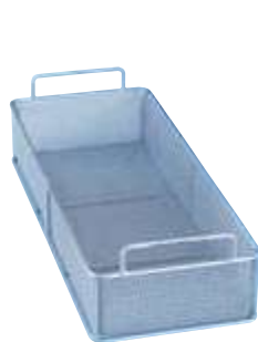
E 379 innsats 1/2 instrumentrist • Trådgitter med 1,7 mm maskevidde • 2 håndtak • H 80 + 30, B 180, D 445 mm Mat.nr. 3203500 Art.nr. 69.5379.01
