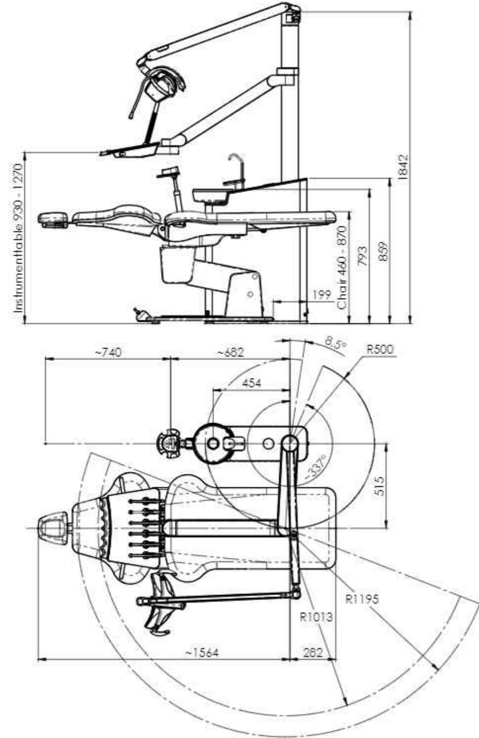
Denne tegningen er basert på en Unicline S med integrert fontene. Unicline S eller enkeltdeler er designbeskyttet og enkelte deler er patentbeskyttet.
