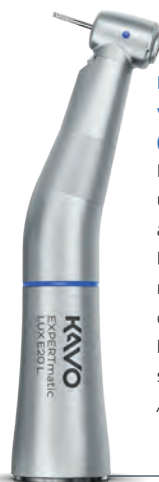
EXPERTmatic LUX E25 L uppväxlat vinkelstycke (1:5) Styrbusning i karbid, ljus- ledarstav i glas med upp till 25 000 lux, snabbt och exakt arbete tack vare det lilla huvudet, flexibel snäppfunktion och keramiskt kullager, vatten- och luftspray som leds internt, spray med tre munstycken och utbytbara sprayfilter Art. nr. 1.007.5550
